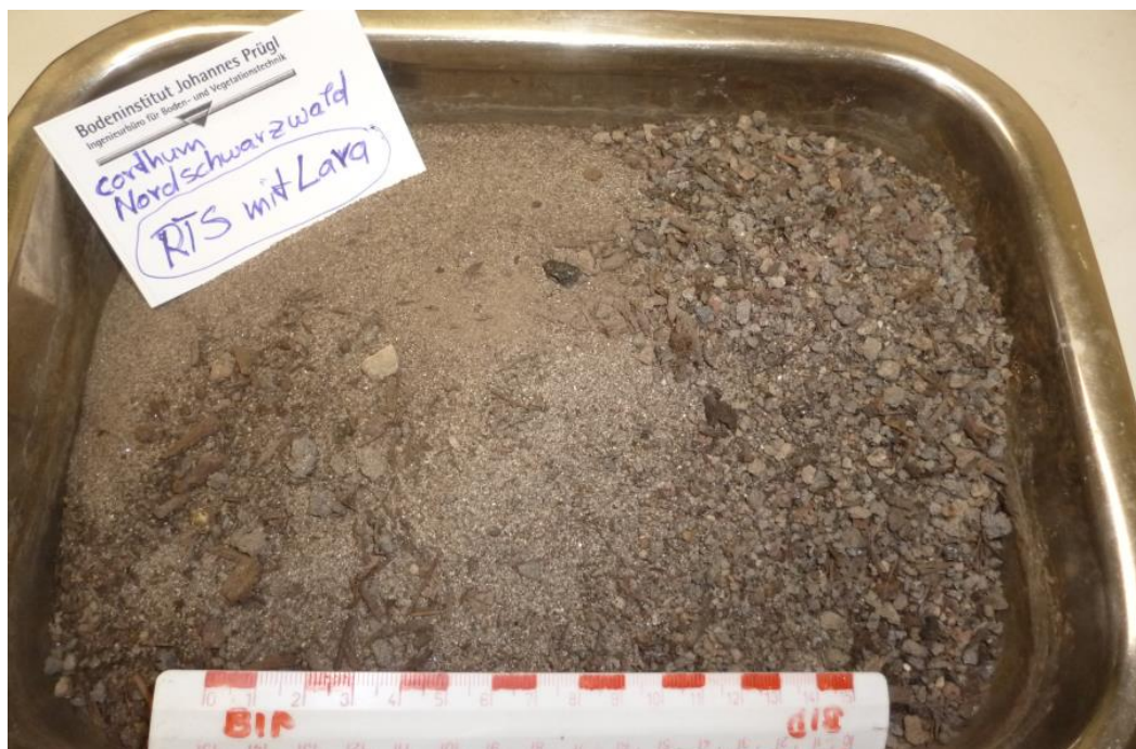
Abbildung 1: Substrat (Gerüstbaustoffe > 0,063 mm) nach Waschen und Sieben
